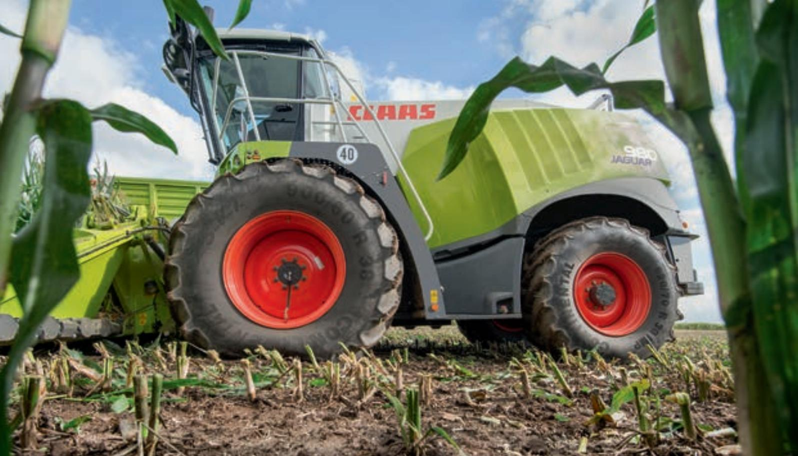
Эксклюзивная функция в секторе силосоуборочных комбайнов: регулировка давления в шинах нажатием кнопки.
